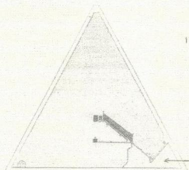
Le premier plan en coupe de LGP réalisé par Benoît de Maillet en 1735 ne fait pas mention de la percée du Kalif Al-Mamoun, alors que celle-ci fut créée au IXème siècle. Ce tunnel n'était pas visible de l'extérieur (recouvert par le sable) et de l'intérieur (occulté par les bouchons de granite)
